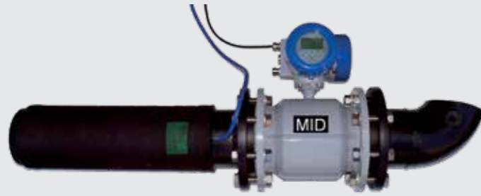
Bild 2 Mobiles magnetisch induktives Durchflussmessgerät (MID) Quelle: AZV Kinzig- und Harmersbachtal
